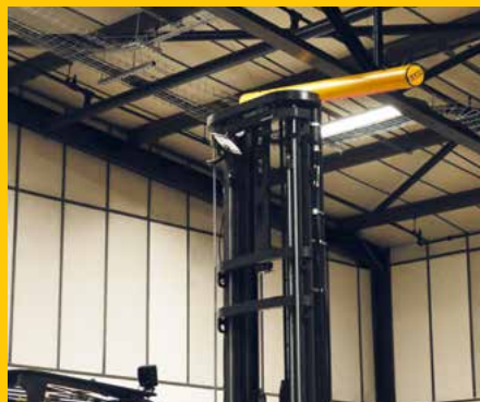
Alarm Bar poskytuje vizuální upozornění řidiči manipulační techniky.
